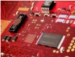
Impedanzkontrollierte Leiterzüge am Beispiel der „Leiterplatte 2010“
