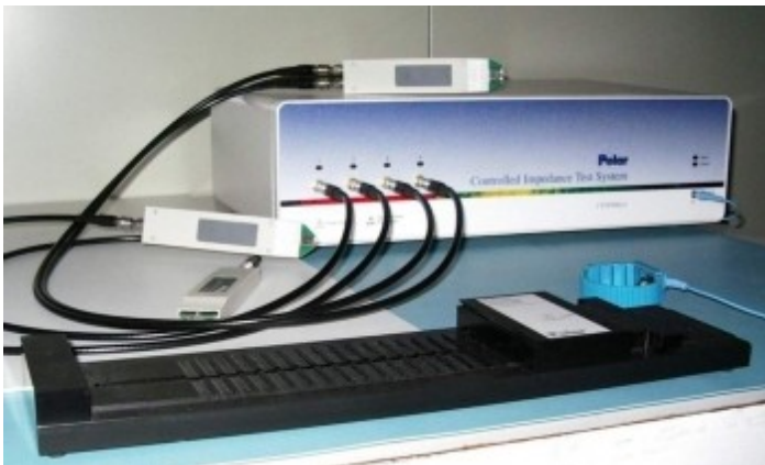
Impedanzmessgerät der Firma Polar im Einsatz beim Leiterplattenhersteller Jenaer Leiterplatten
