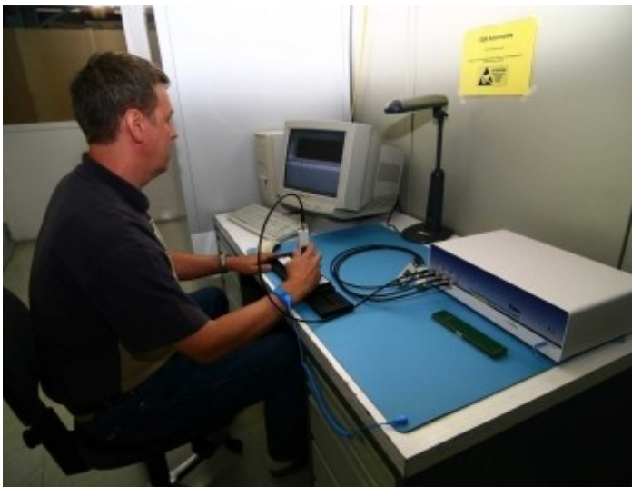
Messplatz für impedanzkontrollierte Leiterplatten bei Jenaer Leiterplatten
