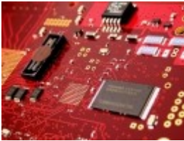
Impedanzkontrollierte Leiterzüge am Beispiel der „Leiterplatte 2010“
