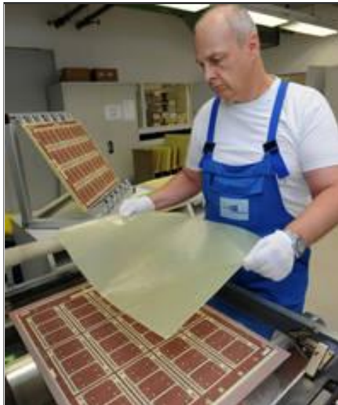
Henry Gehrke beim Eintafeln einer Leiterplatte, die über mehrere Schichten verfügt. Foto: Tino Zippel
