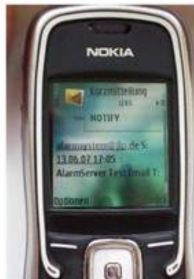
Der automatisch ausgelöste Alarm bei Über- oder Unterschreiten von Grenz- oder Alarmwerten wird per E-Mail und SMS an die zuständigen Mitarbeiter weitergeleitet
