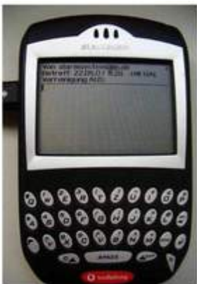
Der automatisch ausgelöste Alarm bei Über- oder Unterschreiten von Grenz- oder Alarmwerten wird per E-Mail und SMS an die zuständigen Mitarbeiter weitergeleitet
